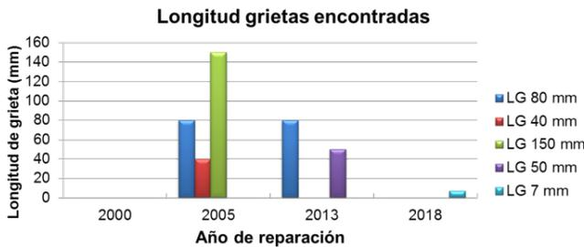
Figura 33: Longitud de grietas versus año de reparación
