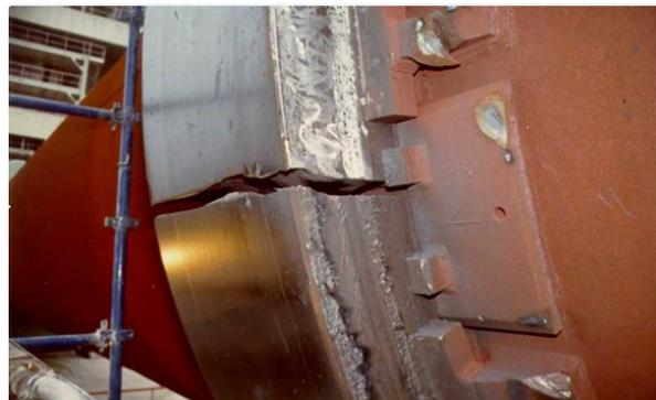
Figura 9: Falla típica de llanta por fractura transversal
