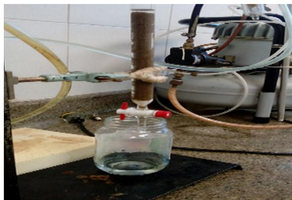
Figura 9: Prueba 0. Agua destilada como fluido de desplazamiento
